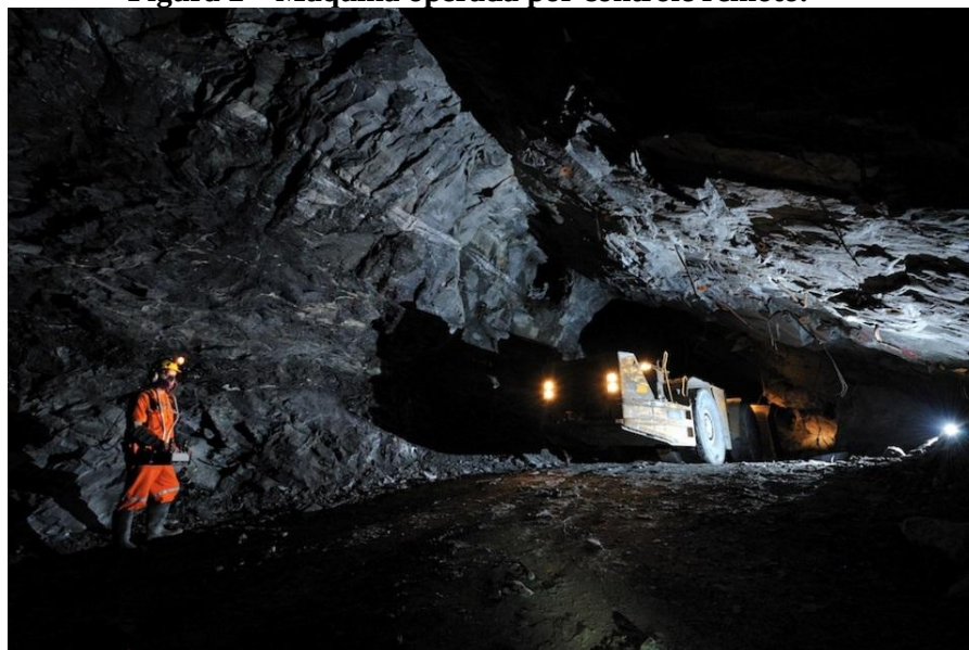
Figura 2 – Máquina operada por controle remoto.
